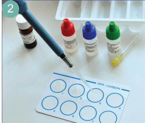
Geben Sie mit einer Pipette 50µl der zu untersuchenden Probe (Plasma oder Serum) auf ein Reaktionsfeld der Karte.
